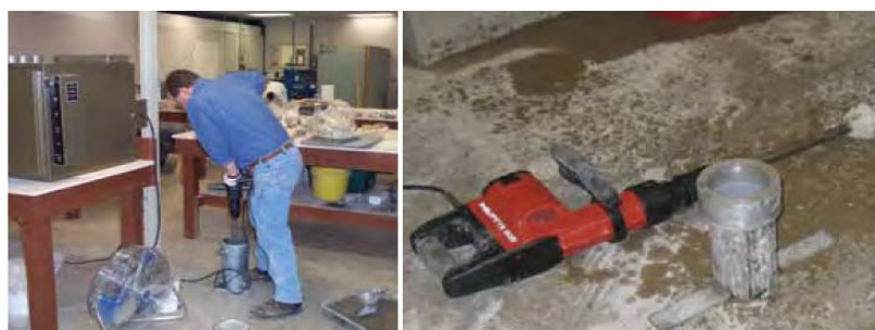
شکل ۳-۶ ساخت نمونه‌های آزمایشی RCCP با استفاده از چکش ضربه‌ای
