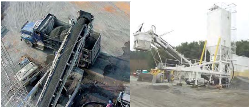
شکل ۴-۵ استفاده از قیف در انتهای تسمه نقاله
