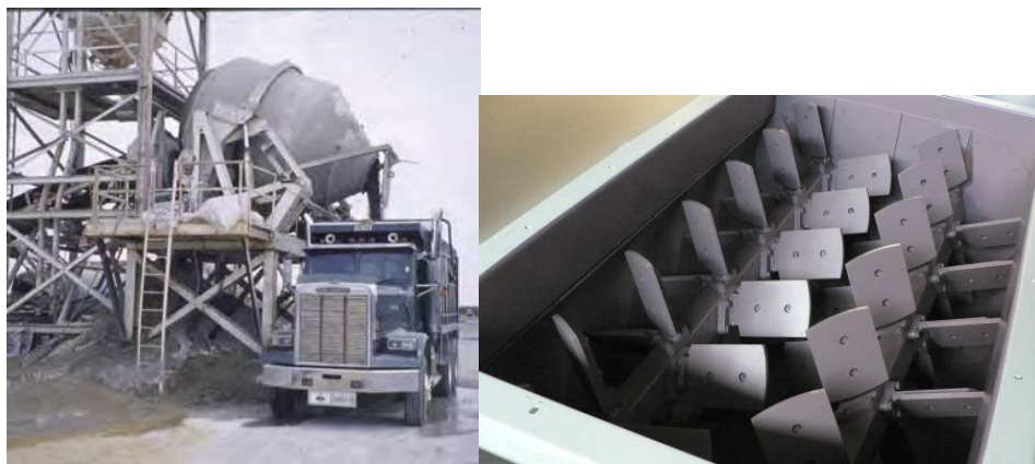
شکل ۱-۴ (سمت راست) یک نمونه مخلوطکن دو محوره و پیوسته، مخصوص تولید بتن غلتکی، و (سمت چپ) یک نمونه مخلوطکن استوانه‌ای کج شونده (غیر پیوسته)
